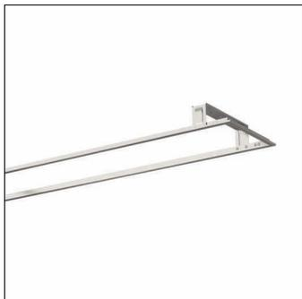
Sport 31, cadre de montage au plafond, type de pose: encastré, cadre de montage, en tôle d'acier, blanc signalisation (RAL 9016), vis incl., longueur: 1.582mm, largeur: 358mm, hauteur: 105mm, système de serrage: 10..60mm, unité d'emballage: 1 pièce
