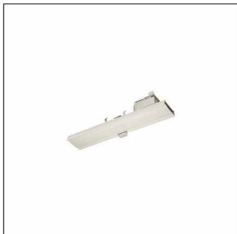
Licross® répéteur, maître, commande locale, contrôle central, gradable, type de pose: encastré, emplacement de pose: sur le rail Licross®, en tôle d'acier, degré de protection (total): IP20, classe de protection (total): classe de protection I (mise à la terre), marquage: CE, UKCA, tension: 230V, type de tension: AC, 1 x DALI, touche de service, 1 x DALI, unité d'emballage: 1 pièce
