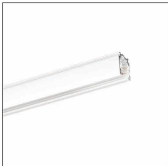
AX T, rail électrique triphasé, type de pose: montage en suspension, en saillie, ballast: ON/OFF, raccordement au secteur: 220..240V/380..400V, AC, en profilé d'aluminium extrudé, laqué, blanc, longueur: 2.000mm, largeur: 32mm, hauteur: 33mm, degré de protection (total): IP20, classe de protection (total): classe de protection I (mise à la terre), marquage: CE, ENEC, unité d'emballage: 1 pièce
