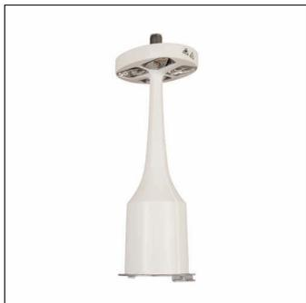
module système électrique, pour module 540 iQ, support d'appareils, ballast: BE iQ, LED flux lumineux: 3.110 lm, température de couleur: 3000K, avec borne, 6 broches, 2,5mm<sup>2</sup> max., raccordement au secteur: 230..240V, AC, 50/60Hz, début de la durée de vie: 19 W, fin de la durée de vie: 21 W, réduction: 10 W, caractéristique d'éclairage primaire: symétrique, largeur: 190 mm, hauteur: 514mm, classe de protection (total): classe de protection II (double isolation), marquage: CE, ENEC, VDE
