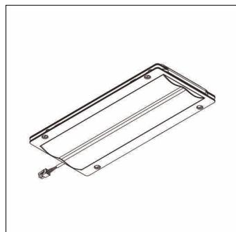
Streetlight 10 mini/midi, module LED, orientation de la lumière primaire avec passage piéton, distribution asymétrique à gauche, répartition de la lumière: PC-L, High Power LED, température de couleur: 750, température de couleur: 5000K, raccordement au secteur: 230..240V, 50Hz, module LED, longueur: 310mm, largeur: 137mm, hauteur: 40mm, degré de protection (total): comparable à un luminaire, unité d'emballage: 1 pièce
