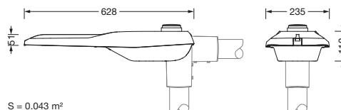
**N° de commande: 5XE6E47N08GB | GTIN (EAN): 4058352897621****Description technique détaillée:**
