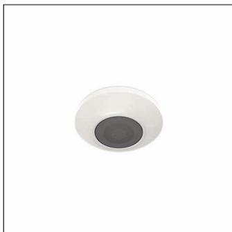
SITECO Connect 11H WirelessNode Multisensor PC9, maître, contrôle local - technologie de capteur autonome, gradable, type de pose: encastré, emplacement de pose: dans le plafond, en plastique, degré de protection (total): IP20, classe de protection (total): classe de protection II (double isolation), marquage: CE, UKCA, tension: 220..240V, type de tension: AC, 1 x capteur de présence PIR, 1 x capteur de luminosité, 1 x DALI, 1 x interface Bluetooth®, unité d'emballage: 1 pièce
