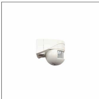
SITECO Connect, multicapteur, type de pose: en saillie, ballast: ON/OFF, raccordement au secteur: 220..240V, AC, 50/60Hz, puissance assignée: 0,9W, boîtier, boîtier, rond, en plastique, blanc, multicapteur, contrôle local - technologie de capteur autonome, équipement: maître, commutable, degré de protection (total): IP54, classe de protection (total): classe de protection II (double isolation), marquage: CE, UKCA, unité d'emballage: 1 pièce
