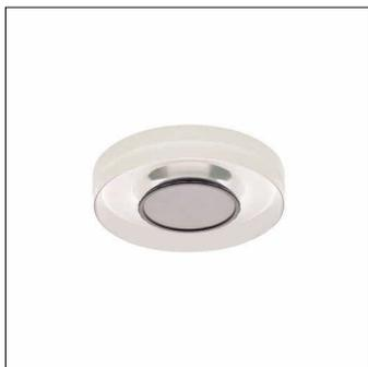
Lunis 11 R, downlight, orientation de la lumière avec réflecteur, haute brillance, diffusion de lumière: direct distribution, LED flux lumineux assigné: 3.830lm, température de couleur: 930, avec borne, 3+2 broches, 2,5mm<sup>2</sup> max., raccordement au secteur: 230V, AC, 50/60Hz, blanc, diamètre: 380mm, degré de protection (total): IP20, classe de protection (total): classe de protection I (mise à la terre), marquage: CE, norme: EN 50419, unité d'emballage: 1 pièce
