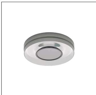
Lunis 11 R, downlight, orientation de la lumière avec réflecteur, haute brillance, diffusion de lumière: direct distribution, LED flux lumineux assigné: 3.790lm, température de couleur: 940, avec borne, 3+2 broches, 2,5mm<sup>2</sup> max., raccordement au secteur: 220..240V, AC, 50/60Hz, argent, diamètre: 380mm, degré de protection (total): IP20, classe de protection (total): classe de protection I (mise à la terre), marquage: CE, norme: EN 50419, unité d'emballage: 1 pièce
