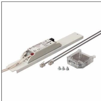
Monsun® 11/21, kit DALIeco Master, tipo di montaggio: montaggio a incasso, con cavo con connettore RJ-11 + 4x conduttore singolo 0,75mm<sup>2</sup>, AC, 50/60Hz, lunghezza: 250mm, larghezza: 34mm, altezza: 29mm, controller DALIeco, master, sensore HC1, sensore di luminosità disattivato, marchi di qualità: CE, temperatura ambiente operativa ammessa: -25..+35°C, unità d'imballo: 1 pezzo
