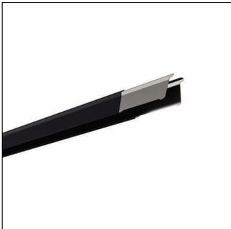
Licross®, canale portante, in lamiera di acciaio, zincata, verniciatura in bobina, nero intenso opaco (RAL 9005), lunghezza: 4.500 mm, larghezza: 64 mm, altezza: 67mm, grado di protezione (totale): massimo IP64, a seconda dei listelli e degli accessori utilizzati, classe di isolamento (totale): classe isolamento I (messa a terra), marchi di qualità: CE, UKCA, conformità LABS testata secondo VDMA 24364:2018-05, unità d'imballo: 1 pezzo
