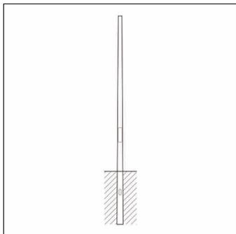
palo, palo, conico rotondo, in acciaio, verniciato con polveri, ferro micaceo Siteco® (DB 702S), altezza: 6,0m, imbocco: 76mm (su palo diritto), messa a terra: alt.= 1000mm / Ø= 153mm, norma: DIN EN 40, unità d'imballo: 1 pezzo
