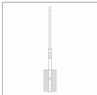
palo, palo, cilindrico rastremato, in acciaio, verniciato con polveri, ferro micaceo SITECO (DB 702S), altezza: 4,0m, imbocco: 76mm (su palo diritto), messa a terra: alt.= 800mm / Ø= 114mm, norma: DIN EN 40, unità d'imbocco: 1 pezzo
