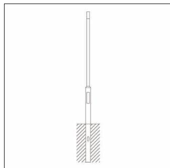
palo, palo, cilindrico rastremato, in acciaio, verniciato con polveri, ferro micaceo SITECO (DB 702S), altezza: 3m, imbocco: 76mm (su palo diritto), messa a terra: alt.= 600mm / Ø= 114mm, norma: DIN EN 40, unità d'imbocco: 1 pezzo
