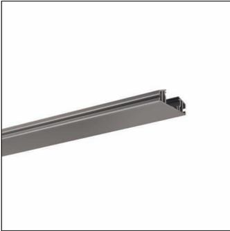
Vega® 11, canale di montaggio, tipo di montaggio: montaggio a sospensione, con morsetto, a 3+3 poli, max. 2,5mm<sup>2</sup>, canale, in alluminio estruso, anodizzato, naturale, lunghezza: 4.000 mm, larghezza: 64 mm, altezza: 22mm, grado di protezione (totale): IP20, marchi di qualità: CE, unità d'imballo: 1 pezzo
