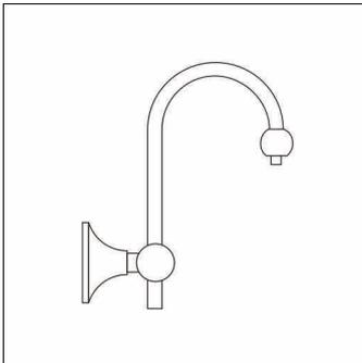
Large Bell, braccio per fissaggio a parete, braccio per fissaggio a parete, in acciaio, zincato, verniciato, ferro micaceo Siteco® (DB 702S), braccio singolo, con dispositivo di chiusura a baionetta, altezza: 1040mm, unità d'imballo: 1 pezzo
