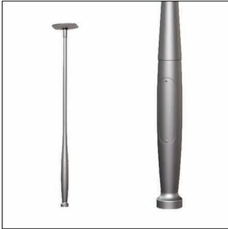
palo, palo, conico rotondo, in alluminio, verniciato, ferro micaceo Siteco® (DB 702S), altezza: 4,0m, imbocco: 76mm (su palo diritto), messa a terra: alt.= 800mm / Ø= 140mm, norma: DIN EN 40, unità d'imballo: 1 pezzo
