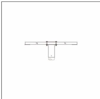
Floodlight FL 20 maxiFloodlight FL 20 midi, gruppo componenti di montaggio, traversa per 2..4 proiettori, in acciaio, zincato, tipo 1: su palo diritto, lunghezza: 1.200mm, imbocco: 89..108mm, unità d'imballo: 1 pezzo
