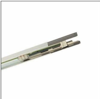
Modario®, canale portante, in lamiera di acciaio, verniciato, bianco, lunghezza doppia, lunghezza: 2.392 mm, larghezza: 58 mm, altezza: 43mm, cablaggio passante: 5x 2,5mm<sup>2</sup>, con morsetto, a 5 poli, max. 2,5mm<sup>2</sup>, grado di protezione (totale): per grado di protezione IP20/IP40, classe di isolamento (totale): classe isolamento I (messa a terra), marchi di qualità: CE, ENEC, VDE, norma: EN 60598, unità d'imballo: 1 pezzo
