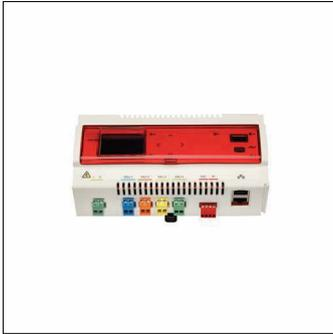
SITECO Connect 21Hcontroller, master, controllo centrale, dimmerabile, tipo di montaggio: montaggio a incasso, luogo di montaggio: in una distribuzione elettrica, unità parte: 6 unità parte, grado di protezione (totale): IP20, classe di isolamento (totale): classe isolamento I (messa a terra), marchi di qualità: CE, tensione: 100..240V, tipo tensione: AC, 1 x collegamento di rete Ethernet, 1 x USB/WiFi, 3 x pulsante di servizio, 4 x DALI-2, 1 x LED di stato, unità d'imballo: 1 pezzo
