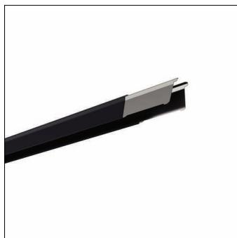
Licross, canale portante, in lamiera di acciaio, zincata, verniciatura in bobina, nero intenso opaco (RAL 9005), lunghezza: 1.500 mm, larghezza: 64 mm, altezza: 67mm, cablaggio passante: 9x 2,5mm<sup>2</sup>, grado di protezione (totale): massimo IP64, a seconda dei listelli e degli accessori utilizzati, classe di isolamento (totale): classe isolamento I (messa a terra), marchi di qualità: CE, UKCA, conformità LABS testata secondo VDMA 24364:2018-05, unità d'imbocco: 1 pezzo
