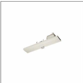
Licross®ripetitore, master, controllo locale, controllo centrale, dimmerabile, tipo di montaggio: montaggio a incasso, luogo di montaggio: sul canale portante Licross®, in lamiera di acciaio, grado di protezione (totale): IP20, classe di isolamento (totale): classe isolamento I (messa a terra), marchi di qualità: CE, UKCA, tensione: 230V, tipo tensione: AC, 1 x DALI, pulsante di servizio, 1 x DALI, unità d'imballo: 1 pezzo
