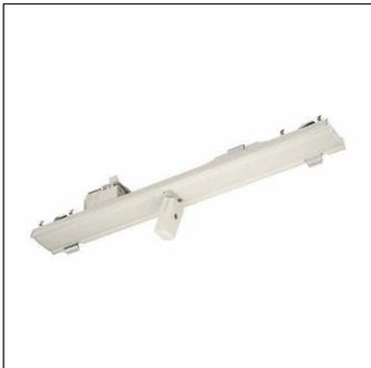
Licross® TrunkingSensor-Module HE1-S, slave, controllo centrale, controllo locale, dimmerabile, luogo di montaggio: sul canale portante Licross®, in lamiera di acciaio, grado di protezione (totale): IP20, classe di isolamento (totale): classe isolamento I (messa a terra), marchi di qualità: CE, UKCA, tensione: 230V, tipo tensione: AC, 1 x sensore di movimento HF, 1 x input sensore di luminosità, 1 x DALI-2, unità d'imballo: 1 pezzo
