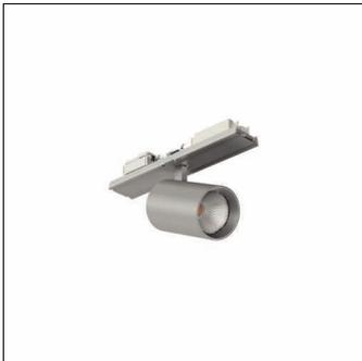
Licross® Spot 31, proiettore direzionale, controllo della luce con lente, in materiale plastico, LED flusso luminoso di misurazione: 5.190lm, colore della luce: 940, alimentatore: EVG-DALI, con spina, a 5 poli, allacciamento alla rete: 220..240V, AC, 50/60Hz, in alluminio, alluminio brillante (RAL 9006), lunghezza: 140mm, diametro: 90mm, grado di protezione (totale): IP20, classe di isolamento (totale): classe isolamento I (messa a terra), marchi di qualità: CE, unità d'imballo: 1 pezzo
