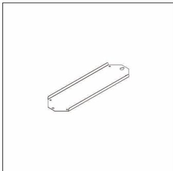
Floodlight FL 11 staffa di fissaggio; staffa di fissaggio dell'unità EVG in acciaio inox, unità d'imballo: 1 pezzo
