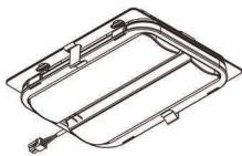
Streetlight 10 micro, LED-Modulo, conduzione primaria della luce con ottica speculare per piste ciclabili, distribuzione luminosa: P1.0a, distribuzione luminosa primaria: asimmetrica, High Power LED, colore della luce: 730, temperatura di colore: 3000K, allacciamento alla rete: 230..240V, 50Hz, LED-Modulo, lunghezza: 174mm, larghezza: 137mm, altezza: 40mm, grado di protezione (totale): come l'apparecchio, unità d'imballo: 1 pezzo
