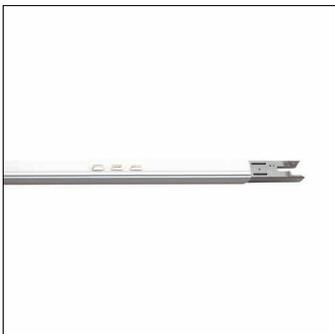
Modario® 31 vano connessioni centrale, bianco; vano connessioni centrale in lamiera di acciaio, zincata, verniciato, con ingresso cavi per sei cavi, Ø 8,5..13mm; 1x diffusore cieco in PC/ABS, bianco, 1x elemento di giunzione in acciaio, zincato, dimensioni: (LxPxA) = 897 x 58 x 43mm; IP40; classe di isolamento: classe isolamento I (messa a terra); marchi di qualità: CE, UKCA; unità d'imballo: 1 pezzo
