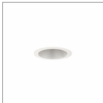
Lunis 31-L, downlight, controllo della luce con riflettore, uscita luce: diretta distribuzione, LED flusso luminoso di misurazione: 1.650lm, colore della luce: 840, allacciamento alla rete: 220..240V, AC/DC, 0/50..60Hz, alloggiamento, in alluminio, bianco, grado di protezione (totale): IP20, grado di protezione (lato locale): IP54, classe di isolamento (totale): classe isolamento II (messa a terra), marchi di qualità: CE, ENEC, unità d'imballo: 1 pezzo
